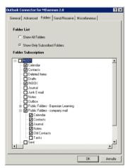
L'interfaccia per la gestione delle cartelle. E' possibile impostare manualmente quali cartelle devono essere visualizzate: tutta la struttura o solo quelle che si desidera.
